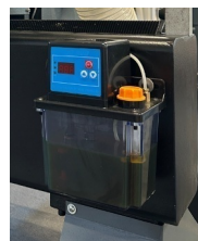
SISTEMA DI LUBRIFICAZIONE AUTOMATICA
