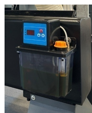
SISTEMA DI LUBRIFICAZIONE AUTOMATICA
